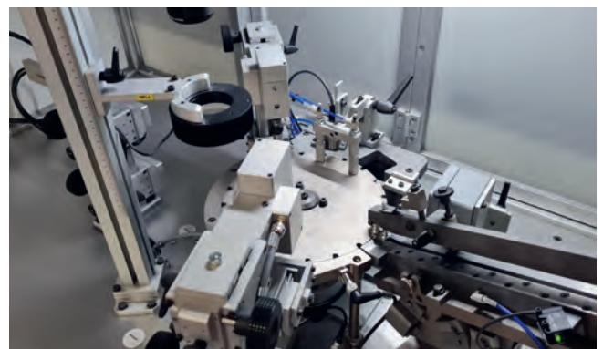
Slot-Teller: Hängende Teile werden seitlich geprüft. 360 Grad- und Wirbelstromprüfungen sind möglich.
